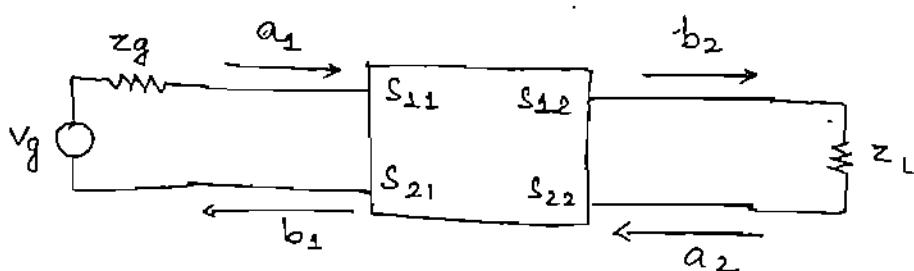
$$\begin{bmatrix} b_1 \\ b_2 \end{bmatrix} = \begin{bmatrix} S_{11} & S_{12} \\ S_{21} & S_{22} \end{bmatrix} \begin{bmatrix} a_1 \\ a_2 \end{bmatrix}$$
