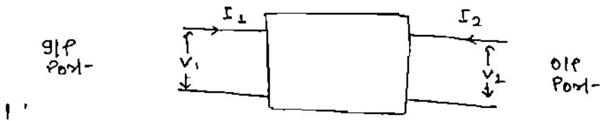
$$\begin{bmatrix} v_1 \\ v_2 \end{bmatrix} = \begin{bmatrix} z_{11} & z_{12} \\ z_{21} & z_{22} \end{bmatrix} \begin{bmatrix} I_1 \\ I_2 \end{bmatrix}$$
